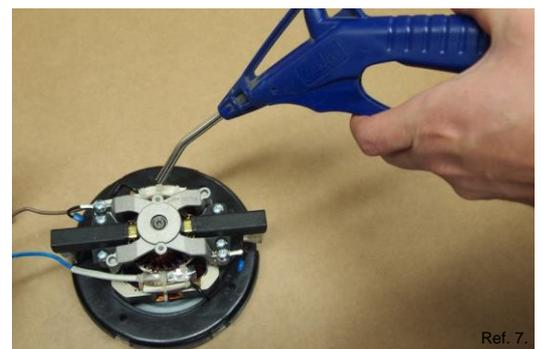
8. Nettoyer à l'air comprimé le capot supérieur et inférieur du moteur.
